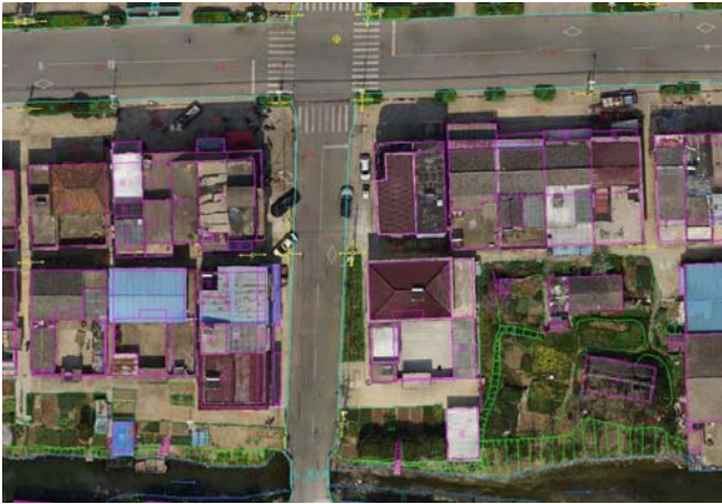
图3 1:500大比例尺测图最终成果示意图
