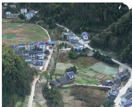
图5 无人机航测过程中生成的河流区域三维模型
