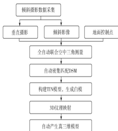
图2 实景三维模型建模的流程
