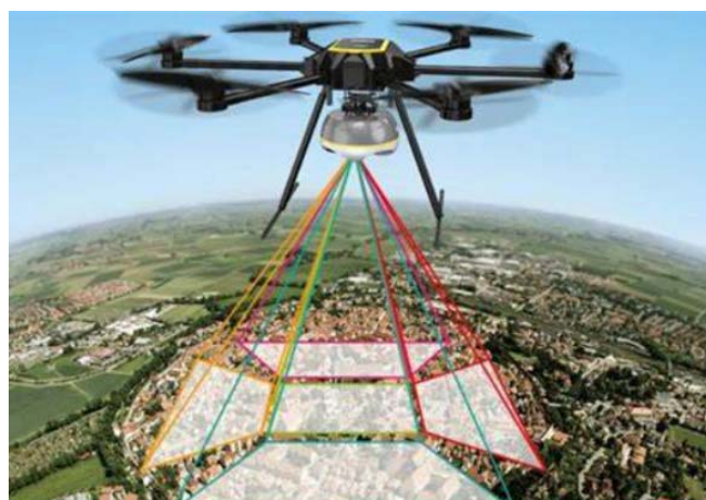
图2 大比例尺地形图测绘中无人倾斜摄影得运用
