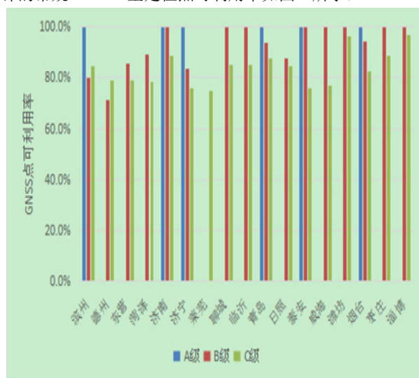
图3 山东省各地市常规GNSS卫星定位点可利用率统计
