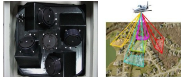
图 1 SWDC-5 倾斜航摄仪及其姿态示意图
