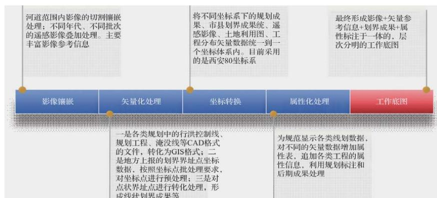
图2 配置工作底图流程
