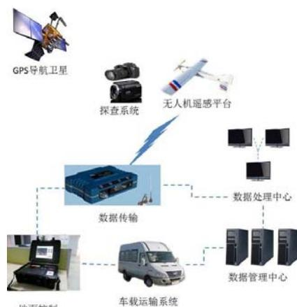
无人机遥感技术的整体技术支持可以呈现成上文的一张图片当中。通过GPS导航卫星的辅助, 运用无人机遥感平台操控探查系统来拍摄相关的测绘测量数
