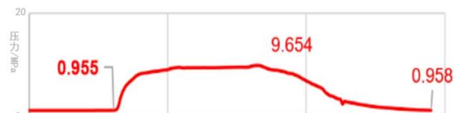
图1 氮气解堵过程中井底流压变化曲线
